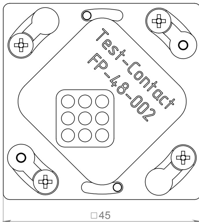
Рис. 1. Габаритные размеры КУ
