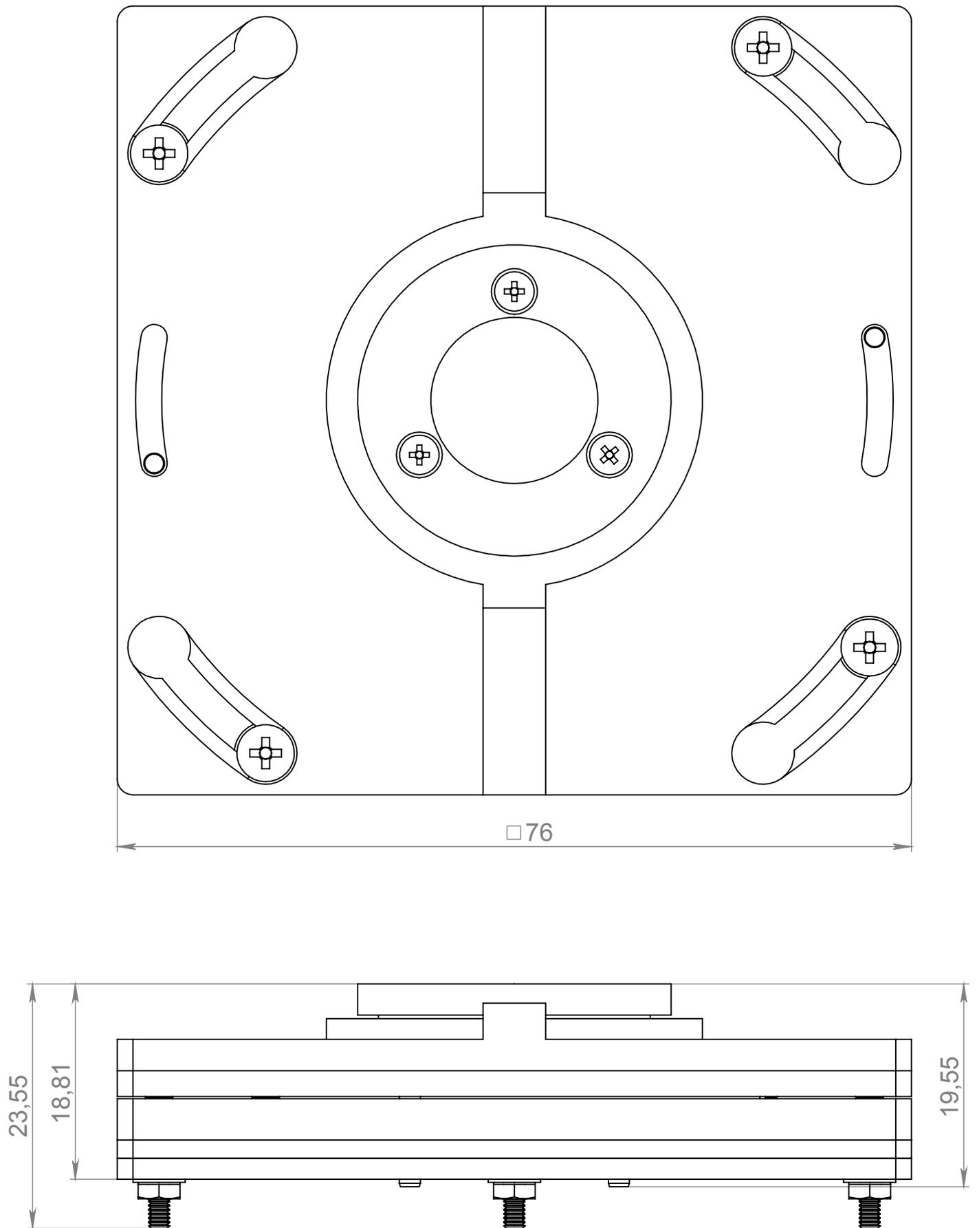
Рис. 1. Габаритные размеры КУ
