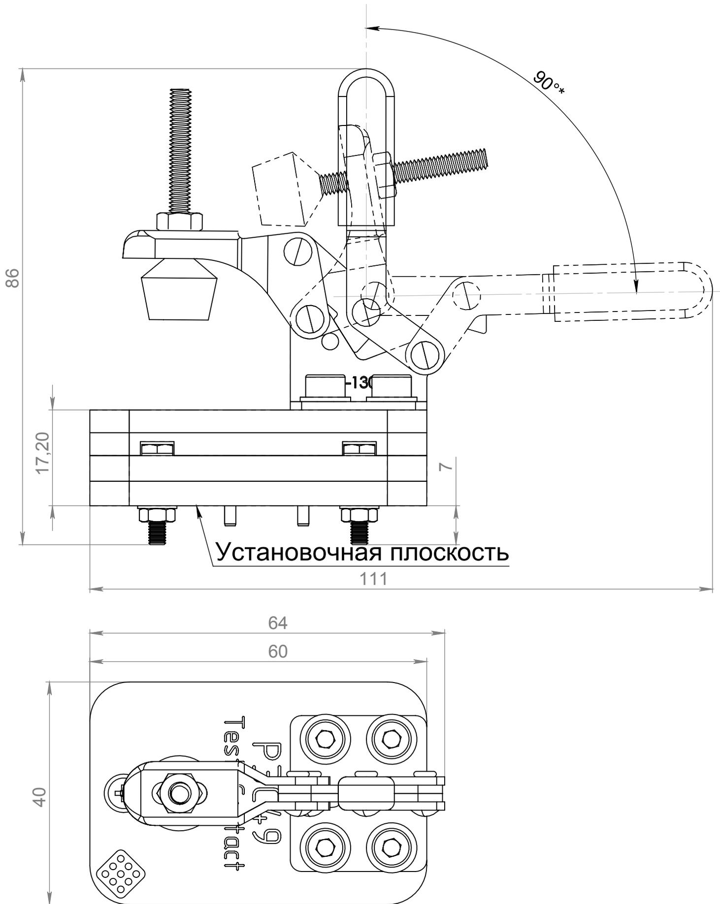
Рис. 2. Габаритные размеры КУ
