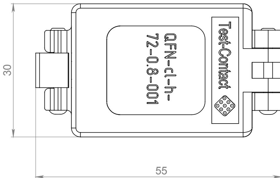
Рис. 1. Габаритные размеры КУ
